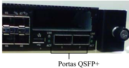
Figura 1. Painel frontal do Comutador PowerConnect 81xx
